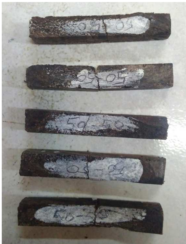
Gambar 2. Gambar bentuk patahan hasil uji impact
