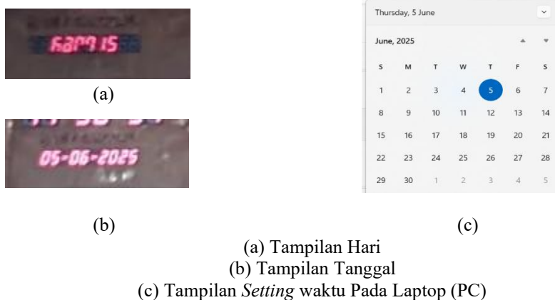
Gambar 8. Pengujian Tampilan Seven Segment Tanggal / Hari
