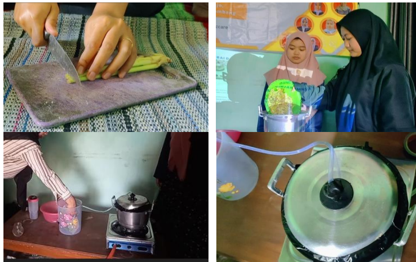
Gambar 4. Praktik Pengolahan Serai Dapur Menjadi Minyak Serai Dapur dengan Metode Distilasi Uap
