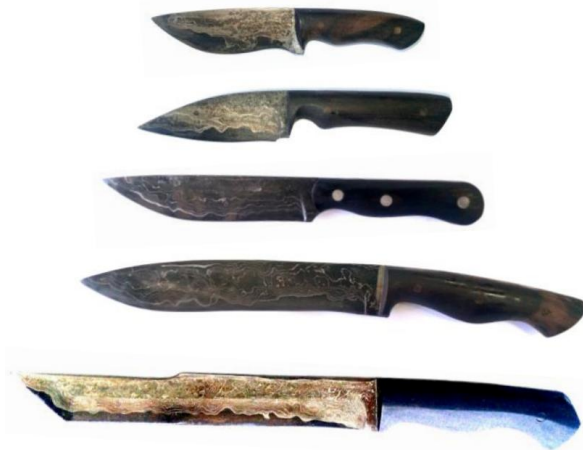
Gambar 5. Beberapa luaran riset berupa aneka bentuk pisau pamor karya kolaborasi antara penulis dengan pande besi dari Koripan (Foto: Kuntadi W. D., 2024)
