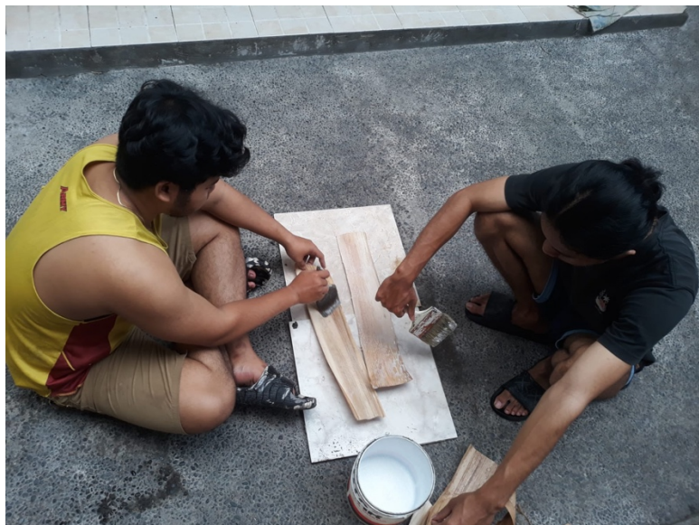
Gambar 9. Proses Pelapisan Lem Fox (sumber: dokumentasi pribadi, 2023)
