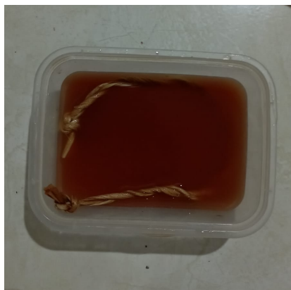
Gambar 11. Merendam Pilinan Pelepah Pisang Pada Cuka Apel (sumber: Dokumentasi Pribadi, 2023)
