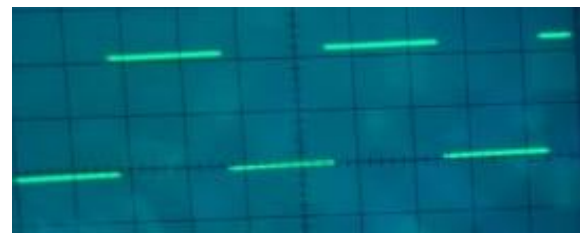
Gambar 10. duty cycle pada tahanan 64 Ohm
