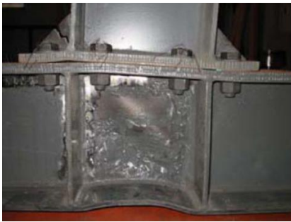
Gambar 8. Pola kegagalan eksperimental [4]
