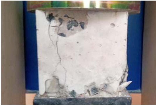
Gambar 9 Benda Uji Kubus 15 dengan Penambahan Tulangan lentur, s = 5 cm
