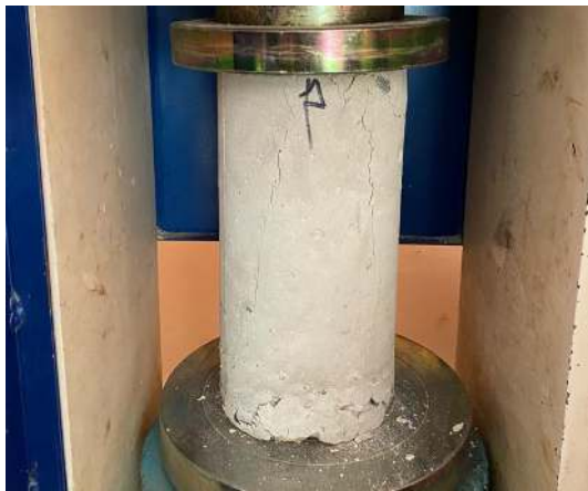
Gambar 13 Benda Uji Silinder dengan Penambahan Tulangan Lentur, s = 5 cm
