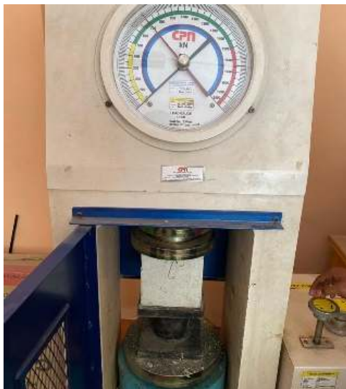
Gambar 2 Benda Uji dan Compression Test
