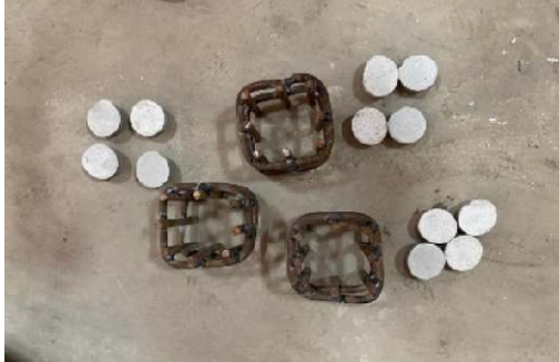
Gambar 1 Penulangan pada Benda Uji
