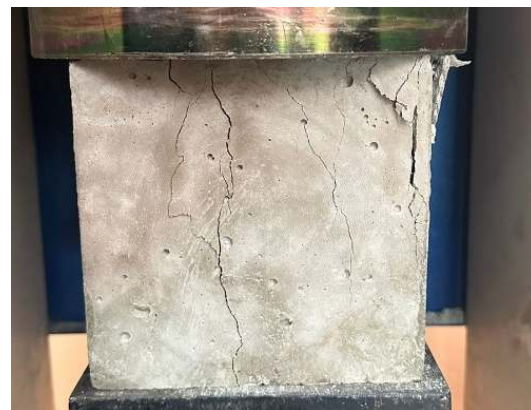
Gambar 8 Benda Uji Kubus 15 cm dengan Variasi Jarak Sengkang, s = 5 cm
