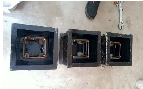
Gambar 3 Tulangan dalam Cetakan Benda Uji
