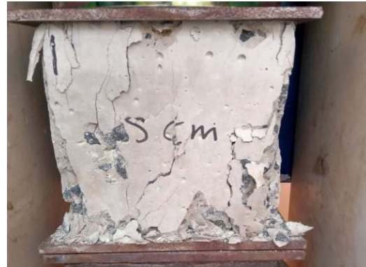
Gambar 11 Benda Uji Kubus 20 cm dengan Penambahan Tulangan Lentur, s = 5 cm
