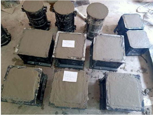
Gambar 5 Benda Uji dalam Cetakan
