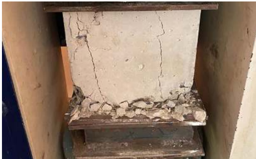
Gambar 10 Benda Uji Kubus 20 cm dengan variasi Jarak Sengkang, s = 5 cm
