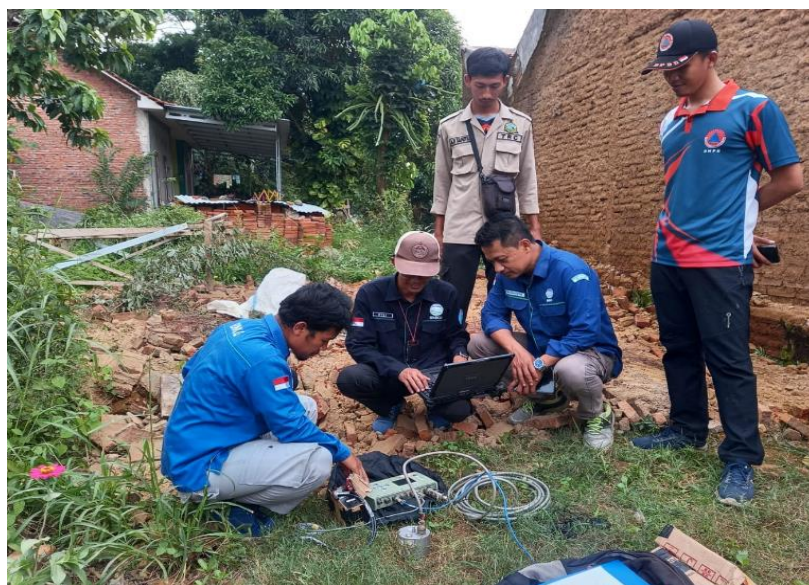
Gambar 3. Pengukuran mikrotremor menggunakan digital portabel seismograph di Perumahan Kalisalak
