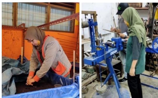
(a) (b) Gambar 3. Uji Kuat Geser: (a) Cetak sampel; (b) Proses uji geser langsung
