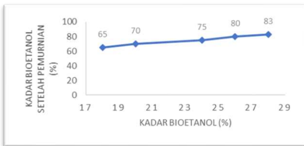
Gambar 6. Grafik Hubungan Kadar Bioetanol Setelah Pemurnian
