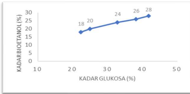
Gambar 5. Grafik Hubungan Kadar Glukosa dan Kadar Bioetanol
