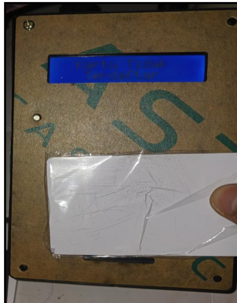
Gambar 4. Pengujian RFID tidak terdaftar
