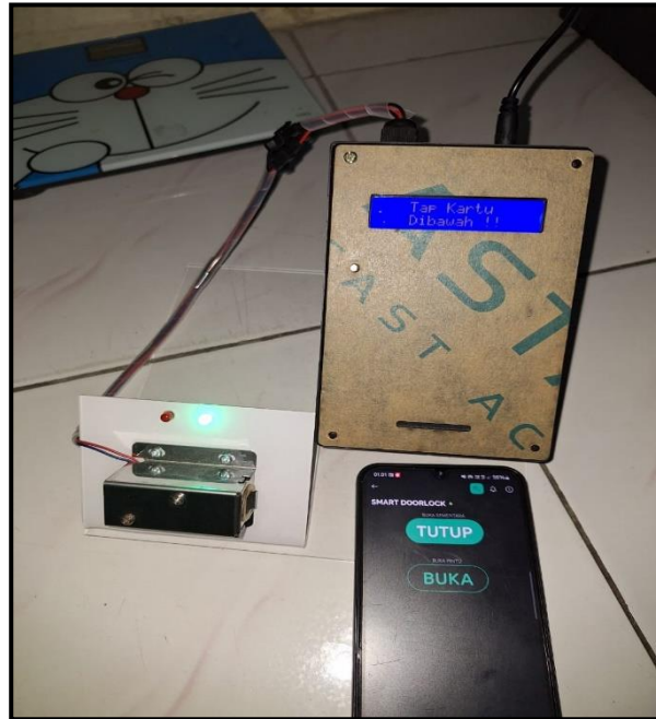
Gambar 7. Pengujian Aplikasi Blynk IoT
