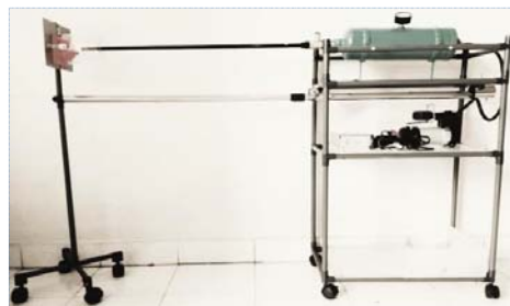
Gambar 1. Alat proses iterasi momentum fragmentasi batubara
