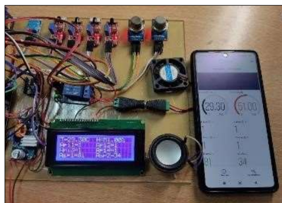
Gambar 6. Tampilan Monitoring Data Sensor LCD dan Aplikasi BLYNK
