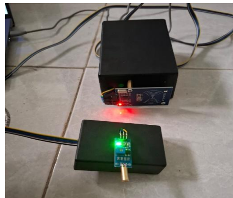
Gambar 5. Rangkaian ESP8266 dengan Sensor Tilt dan Sensor Accelero MPU6050
