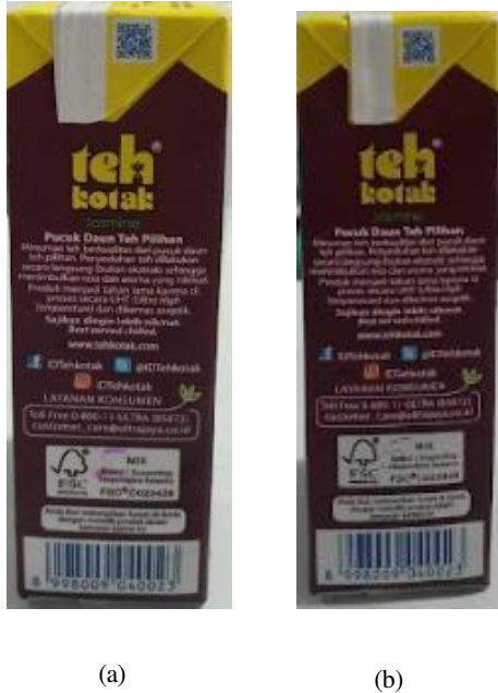
Gambar 5. (a) Citra Kemasan Sebelum dijatuhkan (b) Citra Kemasan Setelah dijatuhkan
