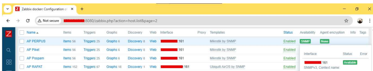
Gambar 3. Zabbix sudah terkoneksi dengan perangkat melalui SNMP
