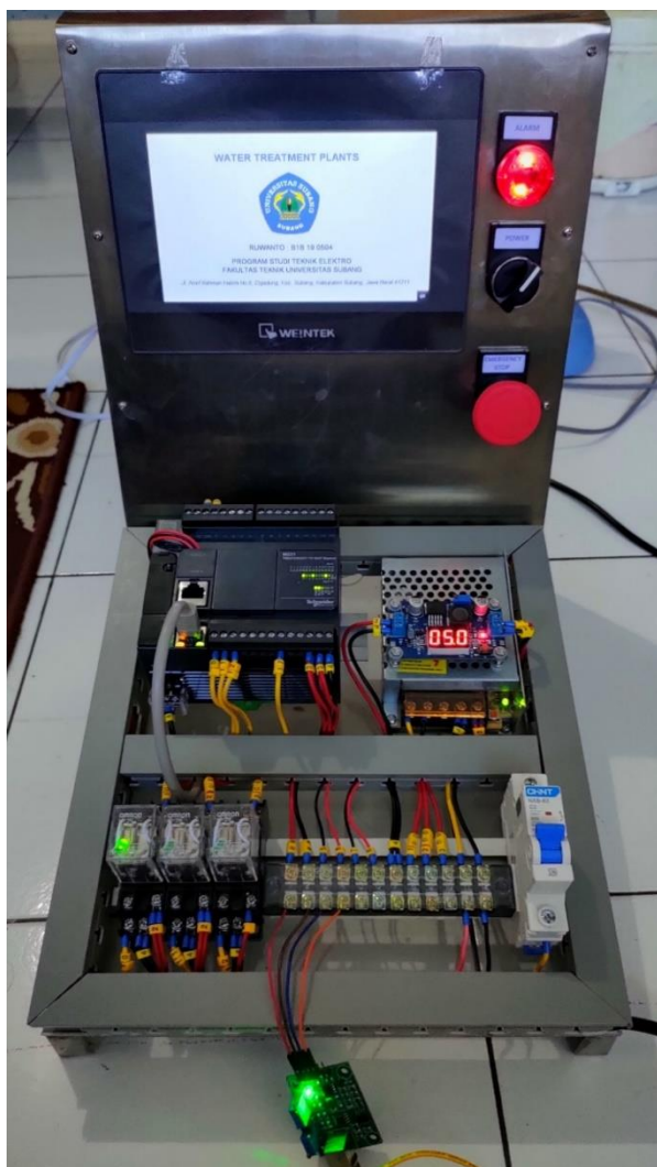
Gambar 19 Prototipe SCADA Koagulasi
