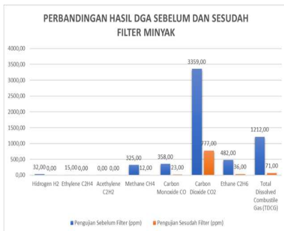
Grafik 1. Perbandingan Hasil DGA Sebelum dan Sesudah Filterisasi Minyak Transformator 1
