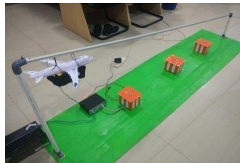
Gambar 4. Hasil Rancangan Simulasi marker beacon (Sumber: Hasil perancangan)
