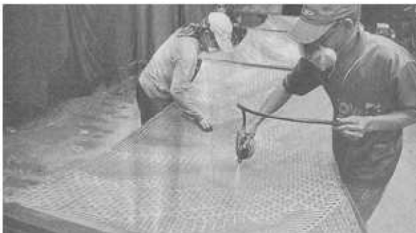
Gambar 9. Teknologi proses: mewarna batik dengan teknik semprot
