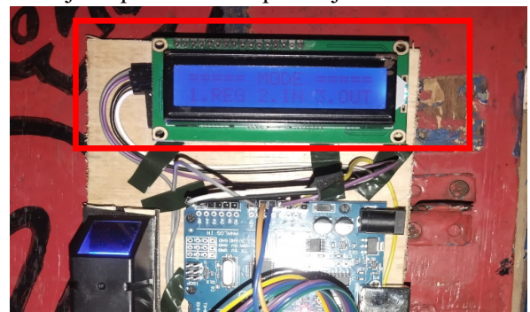
Gambar 16. Sistem Antar Muka Pada Saat Sebelum Membuka Pintu
