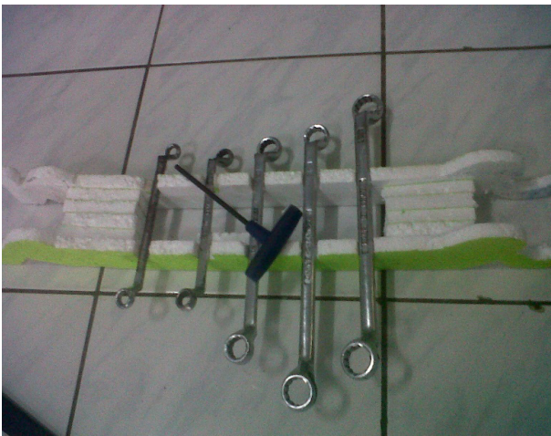
Gambar 7. Perkakas tangan kunci ring kelompok A yang telah dimodifikasi.
