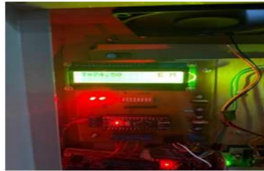
Gambar 3.3 Tampilan LCD Saat Incinerator Beroperasi
