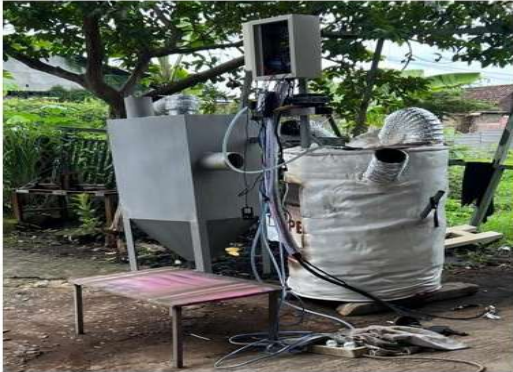
Gambar 3.1 Mesin Pembakar Sampah dengan Filter Asap
