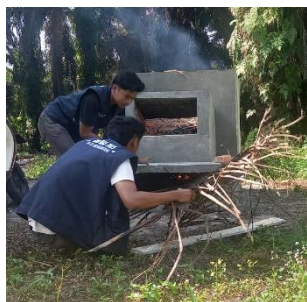
Gambar 2 Uji coba pembakaran sampah menggunakan rocket stove
