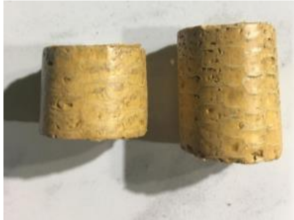
Gambar 3. Modul Silinder Berukuran 2 dan 3 cm
