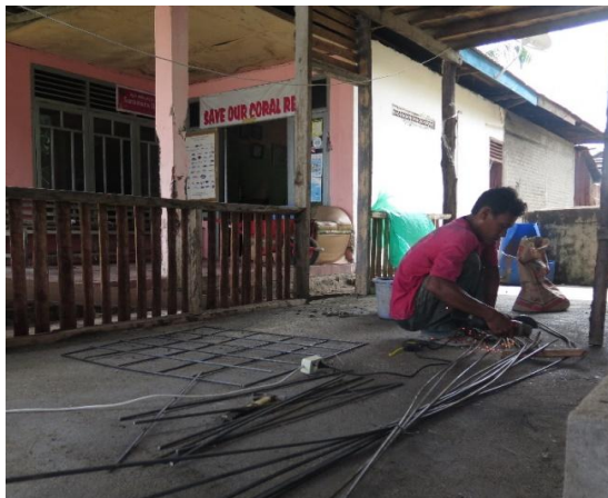
Gambar 2. Pembuatan Rak Transplantasi Karang
