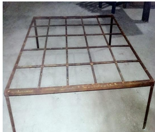
Gambar 2. Pembuatan Rak Transplantasi Karang
