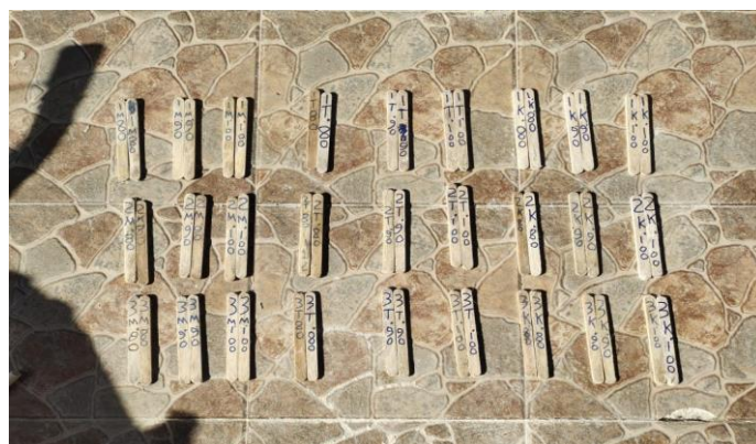
Gambar 5. Spesimen Pengujian Tarik dan Bending
