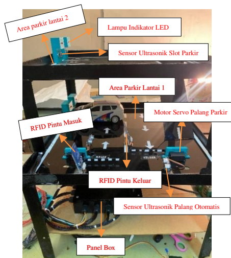
Gambar 1. Kontruksi miniatur smart parking
