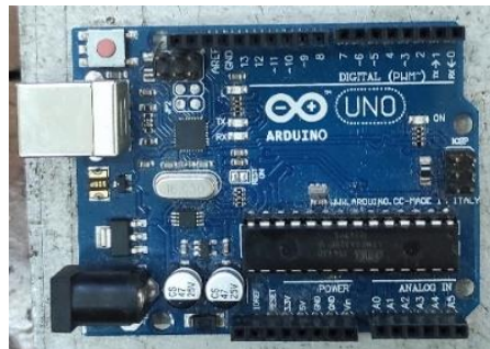
Gambar 2 Arduino Uno Atmega 328
