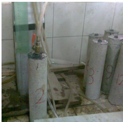
Gambar 4. Setting Up Pengujian Permeabilitas Pada Papercrete Sumber: (Pribadi, 2010)
