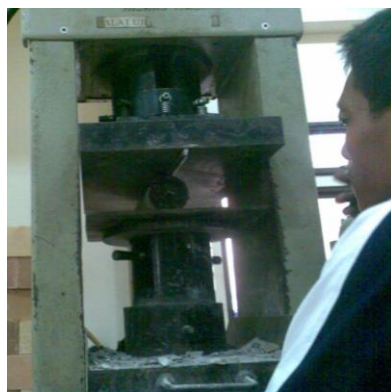
Gambar 5. Hasil Pengujian dan Pengukuran Penetrasi Pada Papercrete Sumber: (Pribadi, 2010)
