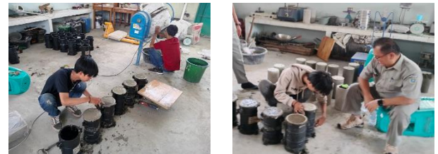
Gambar 1. Pembuatan Sample Beton
