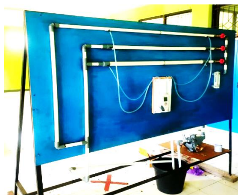
Gambar 4 Alat uji headloss pada pipa lurus dengan variasi debit aliran fluida dan diameter pipa
