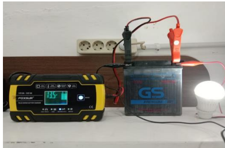
Gambar 8. Kondisi Pengujian Baterai Menggunakan Beban Lampu Pasca PRBC
