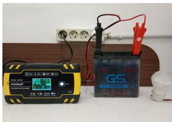
Gambar 6. Instalasi PRBC terhadap Baterai
