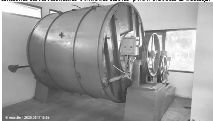
Gambar 1. Mesin Drum Penyamakan Kulit Perkamen, 2025
