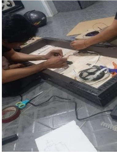
Gambar 5. Instalasi pengkabelan alat (pemasangan lampu led strip)
