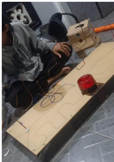
Gambar 7. Pemasangan jalur alat permainan gonggong elektrik
