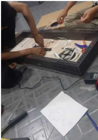
Gambar 6. Instalasi pengkabelan alat (pemasangan power supply)
