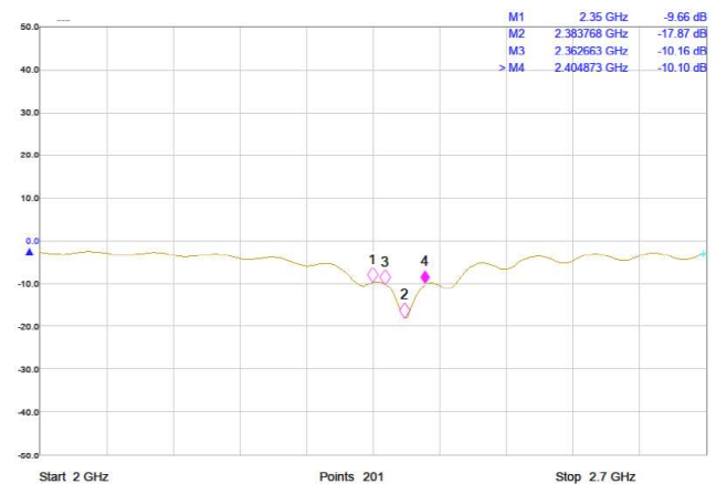
Gambar 13: Hasil Pengukuran Return Loss Antena Elemen MIMO 2 \times 2
