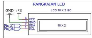
Gambar 4. Rangkaian LCD dengan Modul I2C
