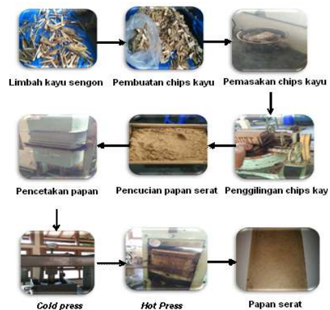
Gambar 3. Diagram alir proses pembuatan papan serat
