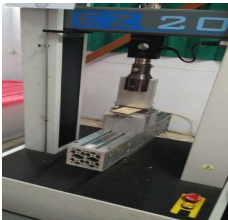
Gambar 4. Skema pengujian MOE dan MOR menggunakan alat uji mekanis ( Universal Testing Machine ).
