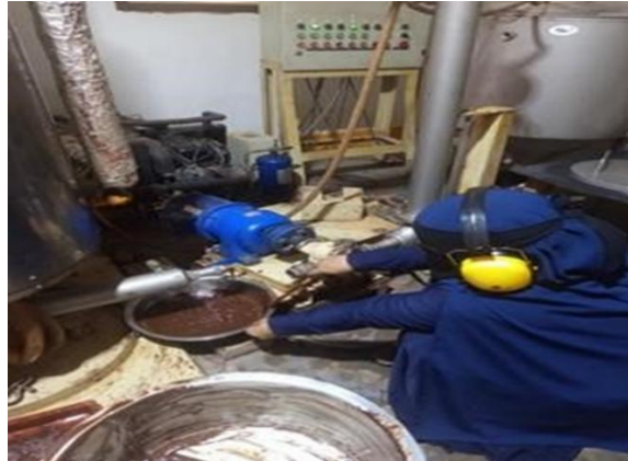
Gambar 3. Pembuatan Pasta Halus Menggunakan Ball Mill
