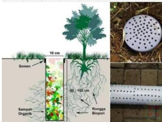
(Sumber : Materi Penyuluhan 2025) Gambar 3. Teknis Pembuatan Lubang Biopori
