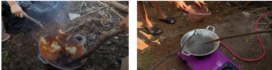
Gambar 1. Proses Eksperimen Pembuatan Paving Block Dari Sampah Plastik
