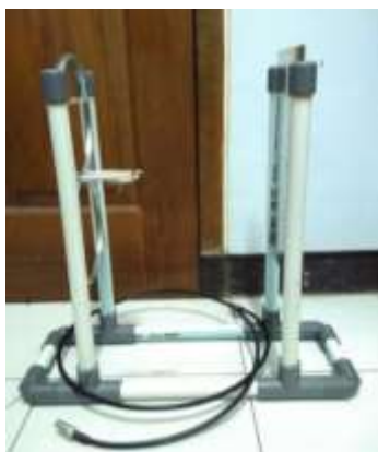
Gambar 6. Fabrikasi antenna dual circular loop lengkap dengan penyangganya
