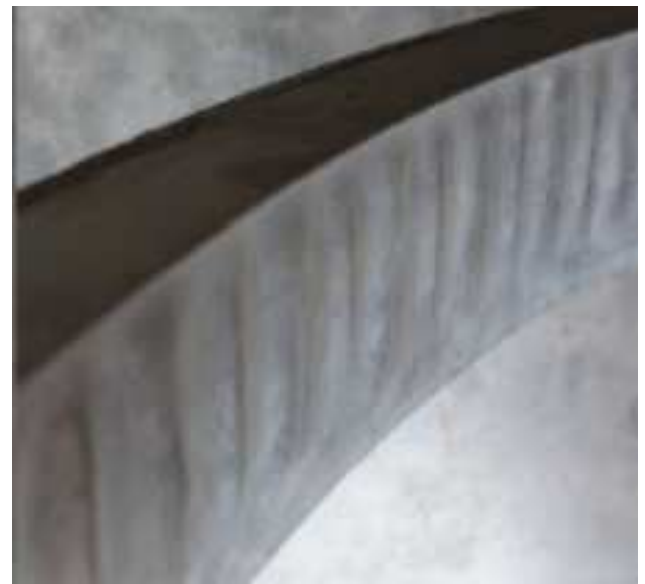
Gambar 4 Wrinkling yang terjadi pada proses roll bending [5]
