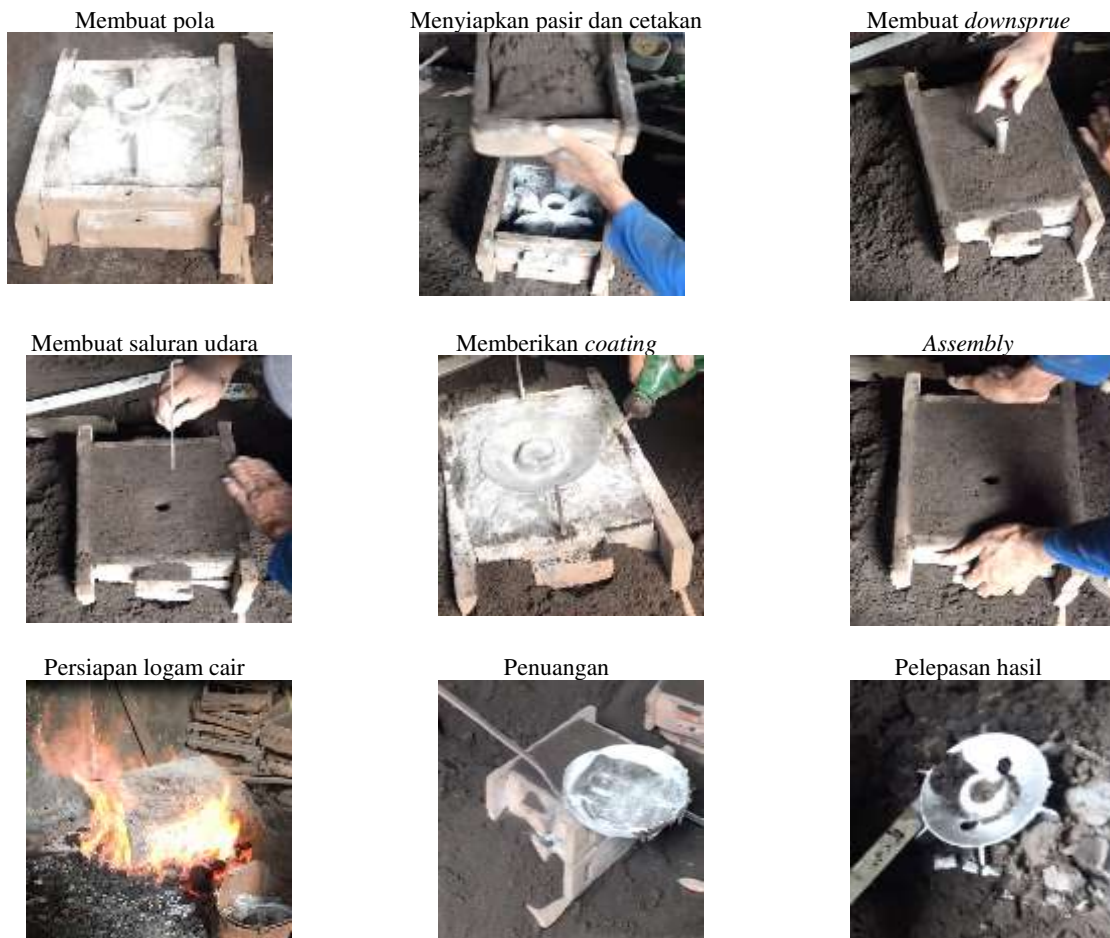
Gambar 4. Proses Pengecoran Komponen Kipas
