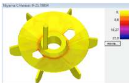
Gambar 7. Hasil Simulasi Kriteria Niyama pada Kipas
