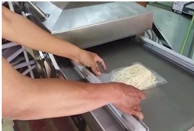
Gambar 3. Proses peletakan mie di Chamber 1
