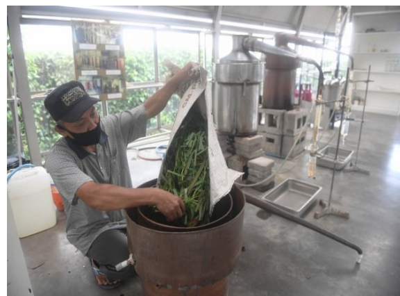
Gambar 1. Destilasi minyak atsiri di RAI
