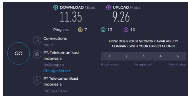
Gambar 9. Hasil speedtest.net SSID Staff dengan Queue Tree aktif
