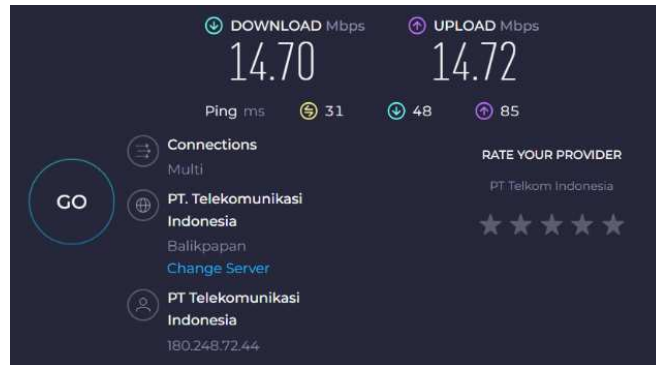
Gambar 8. Hasil speedtest.net SSID Staff dengan Simple Queue aktif
