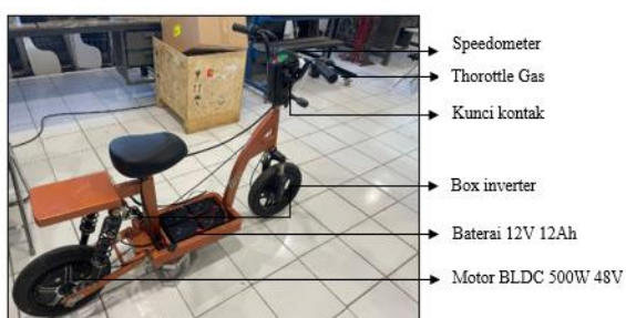
Gambar 4.1 Bentuk Fisik Alat
