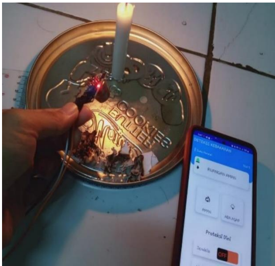
Gambar 3.13 Pengujian sensor asap
