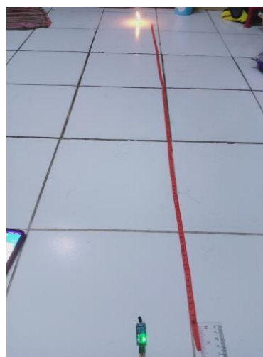
Gambar 3.7 Pengujian sensor api pada jarak 150 cm
