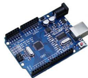
Gambar 2.1 Arduino Uno SMD CH340
