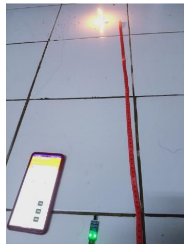
Gambar 3.6 Pengujian sensor api pada jarak 70 cm
