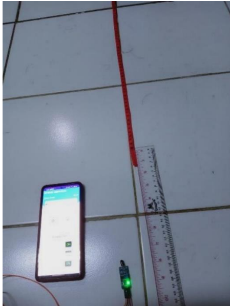
Gambar 3.8 Pengujian sensor api pada jarak 170 cm
