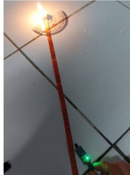
Gambar 3.10 Pengujian sensor api dengan sudut 30°
